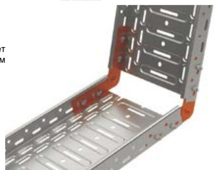
5 Построение горизонтального ответвления с использованием редуцированных частей. Это решение позволяет при необходимости уменьшить ширину трассы. Сначала удаляется часть боковой части с основного широкого лотка, затем таким же образом удаляются боковины у более узкого ответвляющего лотка, далее с помощью болтов крепятся две редуцированные половины на ширину ответвления.
