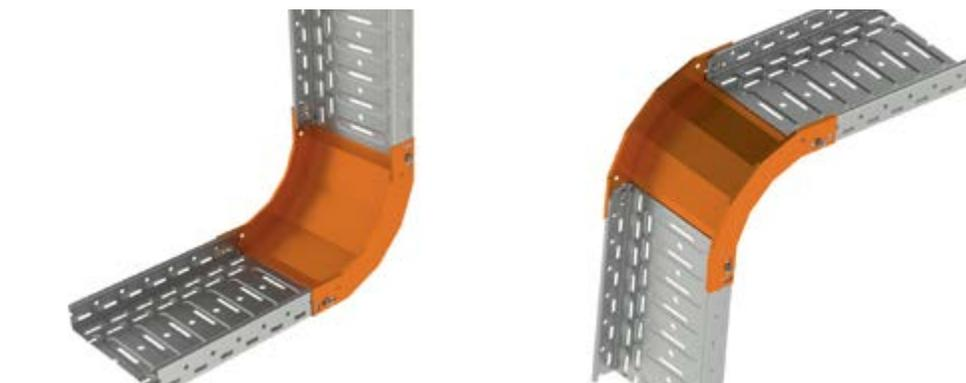
4 Для создания угла, отличного от 90° в вертикальном направлении, служит соединитель шарнирный. Он позволяет изменить направление трассы на от 1° до 75°. Его применение выгодно для создания небольших углов, причем преимуществом шарнирного соединителя является возможность регулировки угла в данном диапазоне.
