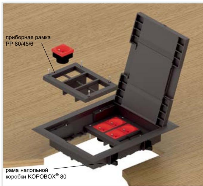
Напольная коробка КОРОВОХ® 80 и приборная рамка PP 80/45/6 предназначены для монтажа шести модульных приборов 45x45. Изделие можно использовать при глубине пола минимум 78 мм.
