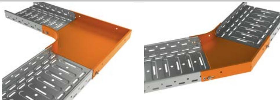
2 Для создания горизонтального поворота трассы, можно использовать также соединитель NSUK. Он позволяет создать горизонтальный поворот трассы по желанию заказчика под требуемым углом. Соединитель изгибается и прикручивается к лоткам с помощью болтов.
