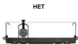
Возможность закрытия трассы крышкой при использовании максимального диаметра кабеля в зажиме.
